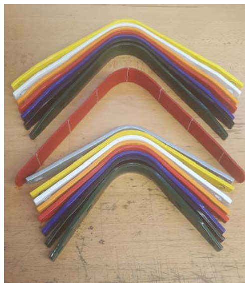
Hier beide Systeme (das längere R-Bar, sowie das kürzere S-Bar-System) und das rote Biegelineal aus dem System des BVFR, mit seinen Markierungen auf 7, 14 und 21.
