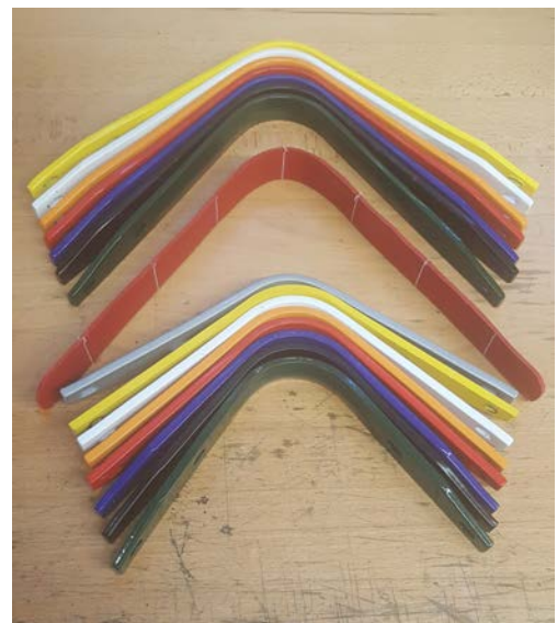
Hier beide Systeme (das längere R-Bar, sowie das kürzere S-Bar-System) und das rote Biegelineal aus dem System des BVFR, mit seinen Markierungen auf 7, 14 und 21.
